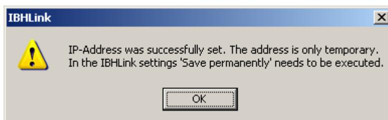
L'indirizzo IP inserito è impostato solo provvisoriamente, fintantoché non verrà eseguito il comando di salvataggio definitivo. Se a questo punto si spegne il NL50-MPI / NT50-MPI, l'indirizzo IP appena impostato con questa procedura di "pre-assegnazione" viene perso.
