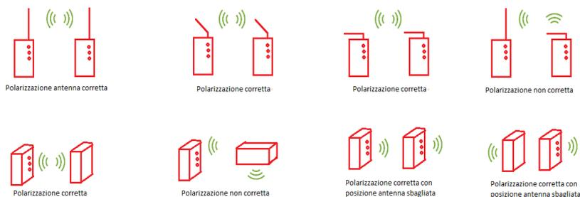
Fig.5 Posizionamento antenne
