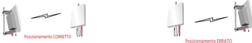
Fig.3 Allineamento antenne
